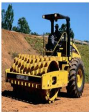
a) Rolo Compactador
