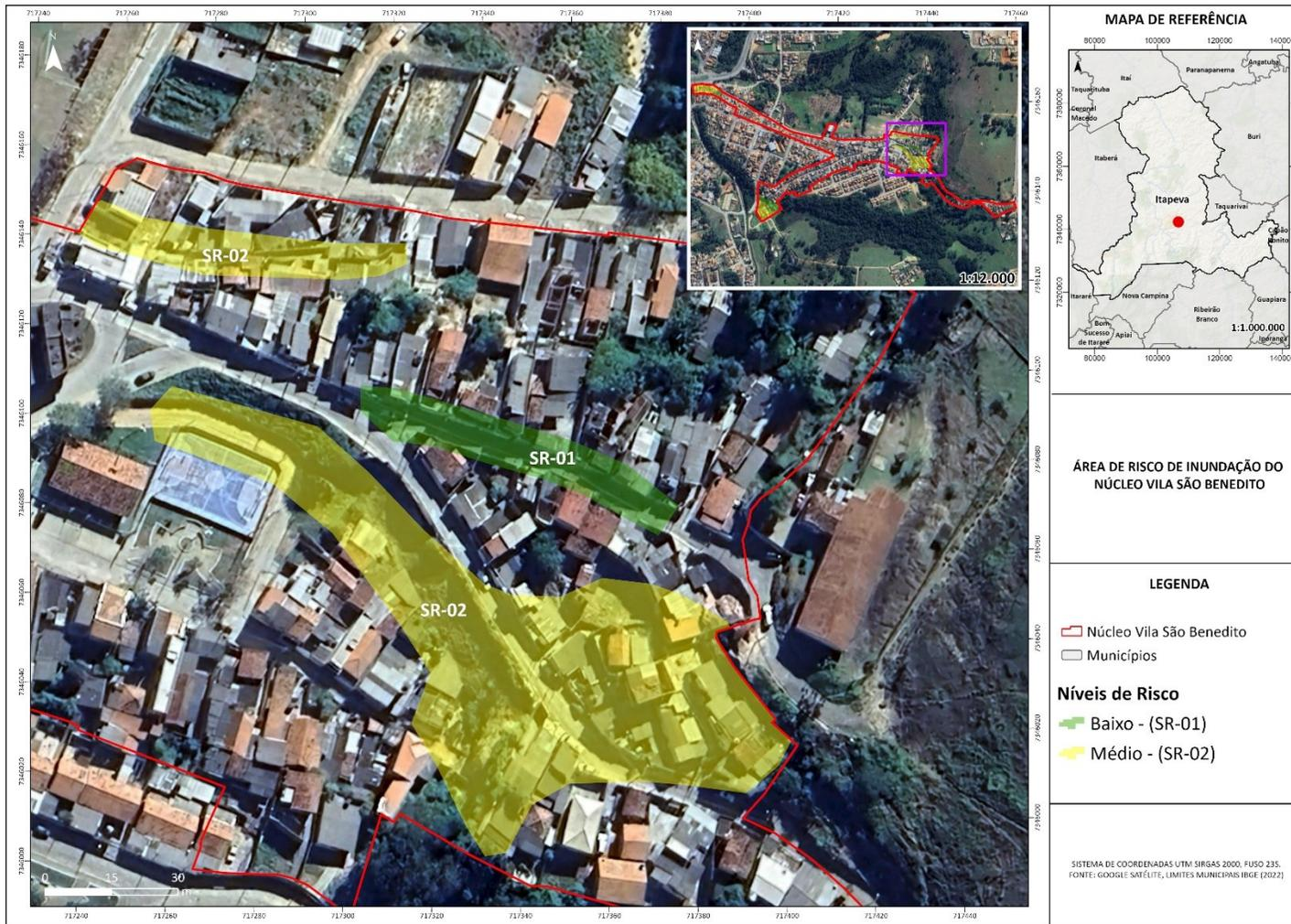
Figura V.c.1 – Áreas de risco de enchurradas em trechos com ruas mais inclinadas no núcleo, propensas a gerar fluxos concentrados de água pluvial. Setores SR-01 (baixo risco) e SR-02 (médio risco). Elaboração própria.
