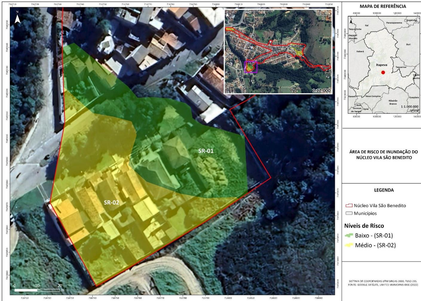
Figura V.c.3 – Áreas de risco de inundação no limite sudoeste do núcleo, em trechos das ruas Santo Antônio de Categero e Ítalo Turiani. Setores SR-01 (baixo risco) e SR-02 (médio risco). Elaboração própria.
