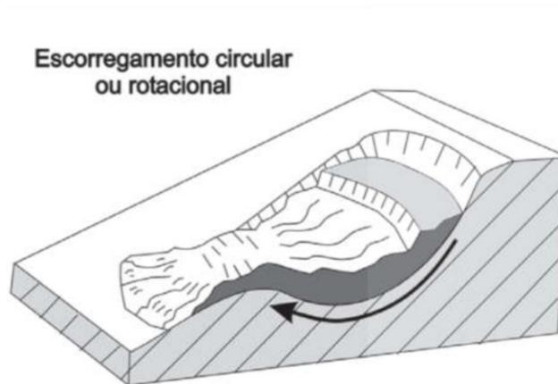
**Figura IV.a.5 – Perfil esquemático do deslizamento circular ou rotacional. Fonte: Ministério das Cidades; Instituto de Pesquisas Tecnológicas – IPT, 2007.**
